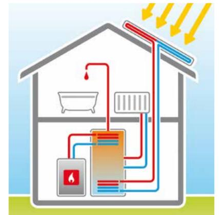
Einbindung einer Solardachanlage in den Heizkreislauf
