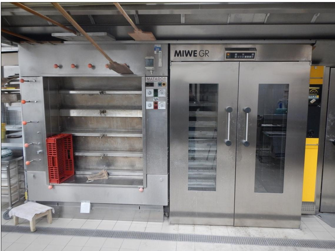
Abbildung 3: Etagenofen (links) und Backschrank (rechts)
