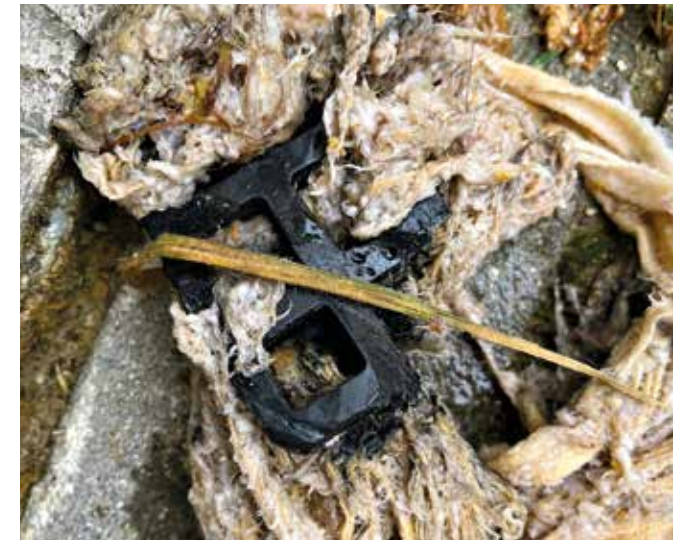
Feuchttücher im Abwasser führen zu schwerwiegenden Schäden an den Pumpen.
