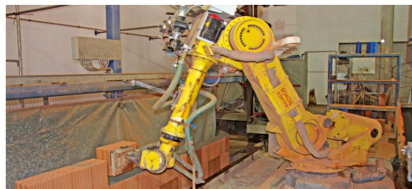
Ein Industrieroboter sorgt für höchste Genauigkeit und Qualität in der Herstellung der Ziegel-Bauteile. Rechts: Mit einem Schwerlastkran werden die Einzelteile auf der Baustelle montiert
