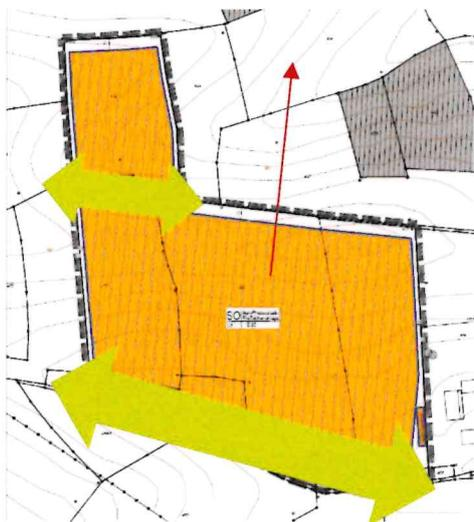
**Variante 1** sieht hangparallele Grünzüge vor. Diese wirken einer Bodenerosion entgegen. Das Modulfeld wird hierdurch in zwei Teilbereiche unterteilt.
