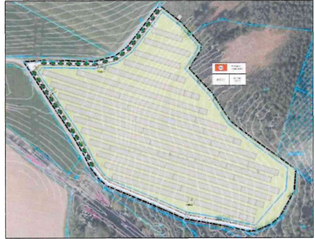
Abb. 14.8.2, zwei randlich gelegene Trafos, Module geländeoptimiert
